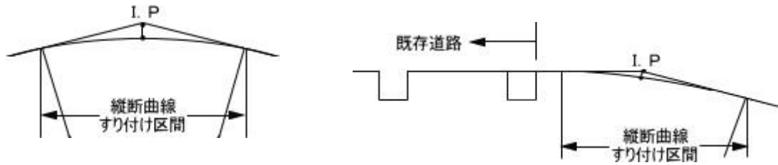
図 - 13 縦断曲線の設置例
