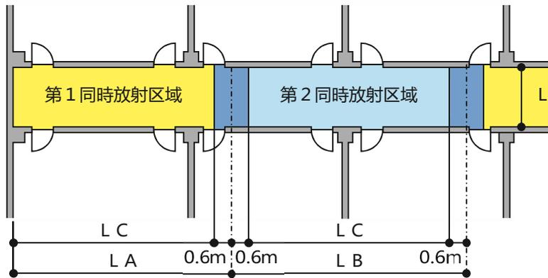
第1同時放射区域  $L \times L\text{A} = L \times (\text{L}\text{C} + 0.6)$
