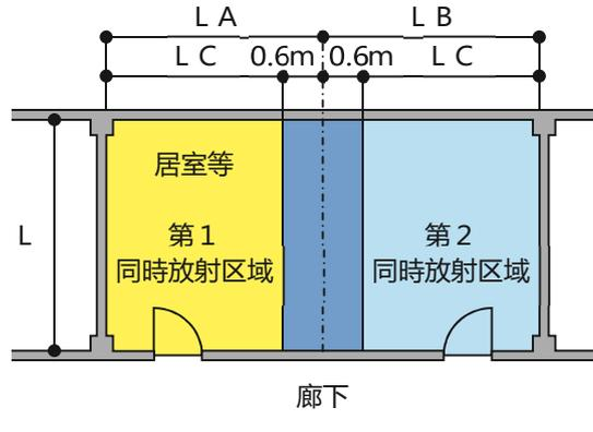
第1同時放射区域  $L \times L\text{A} = L \times (\text{L}\text{C} + 0.6)$
