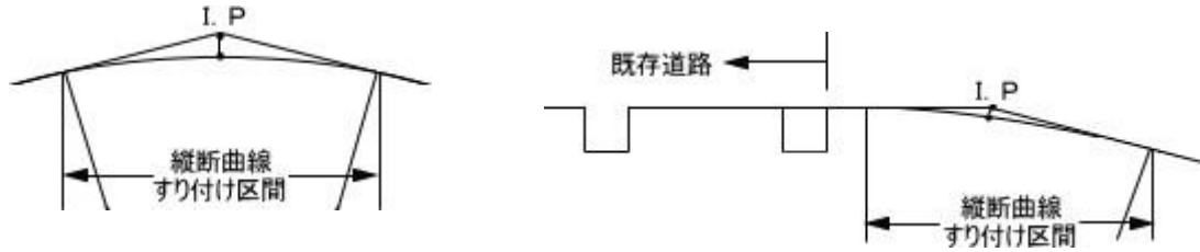
図 - 1 3 縦断曲線の設置例
