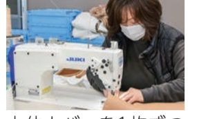
本体カバーを1枚ずつミシンで縫製
