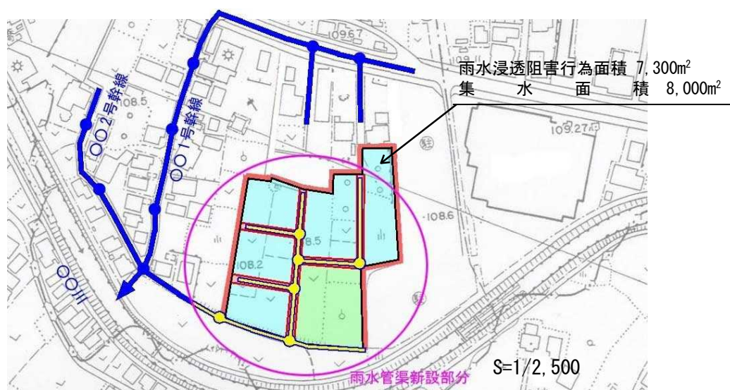
排水施設計画平面図の例
