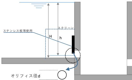
実際の放流量が許容放流量を超えないよう（ただし、可能な限り許容放流量に近似するよう）オリフィスのサイズを設定してください。
