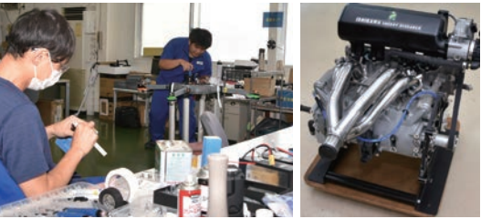
組立や検査を行う工場内(左)と独自技術の「無振動エンジン」を応用した開発中の製品
